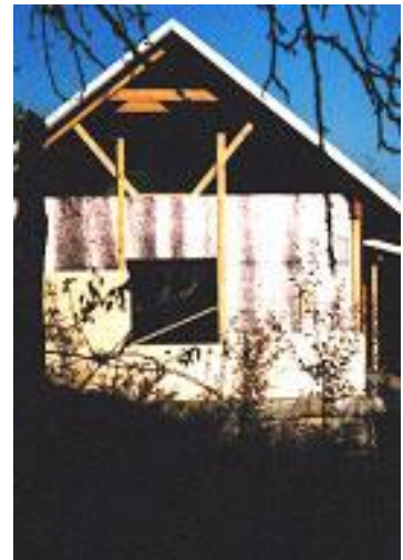
Obr. 15 –17 Umístění RTI v jednotlivých pohledech. RTI pásy jsou spojeny samolepicí pěnovou páskou.
