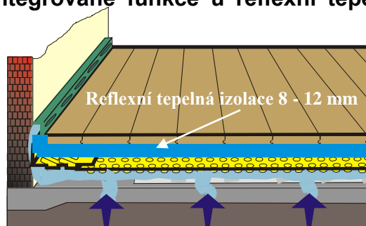
Obr. 3 Zateplení pomocí RTI s pomocí různých nopových folií
